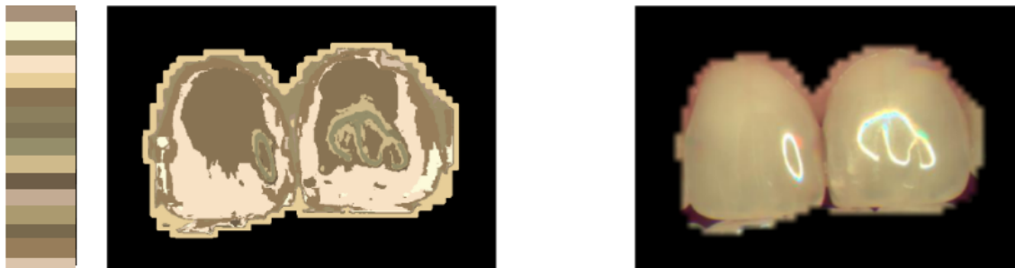
Figura 15: Procesado del color de un diente con los centroides obtenidos de manera experimental.
